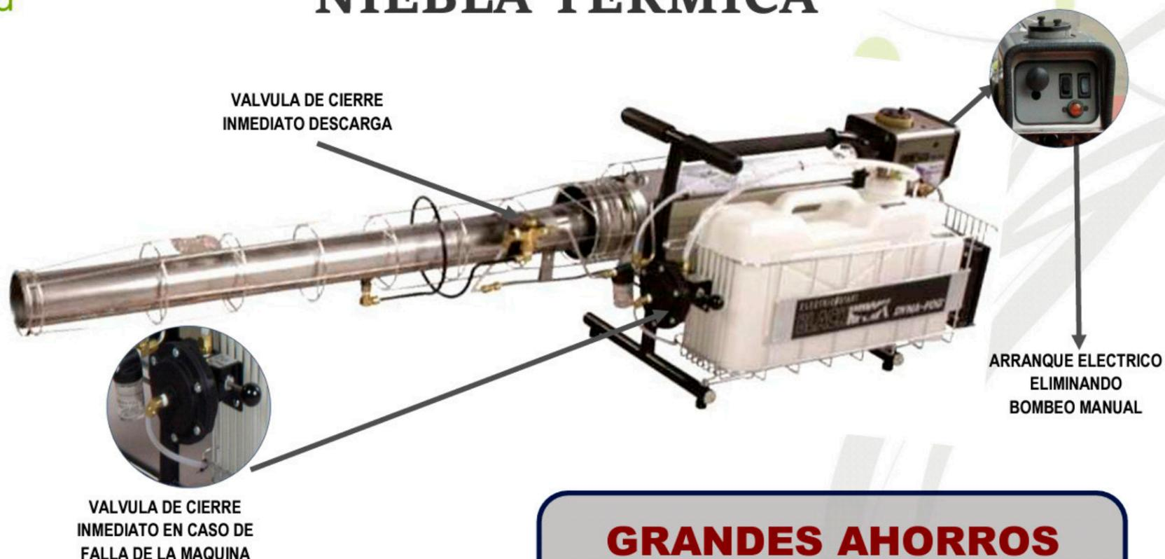
**BLACKHAWK™**, termonebulizador semipesado puede utilizarse de manera portátil o montado en vehículo, equipado con una válvula selector que permite (Si "o" No) instantáneo de niebla y modo de "purgado" Para evitar obstrucciones, posee válvula de cierre automático permitiendo operar el equipo por una sola persona.
